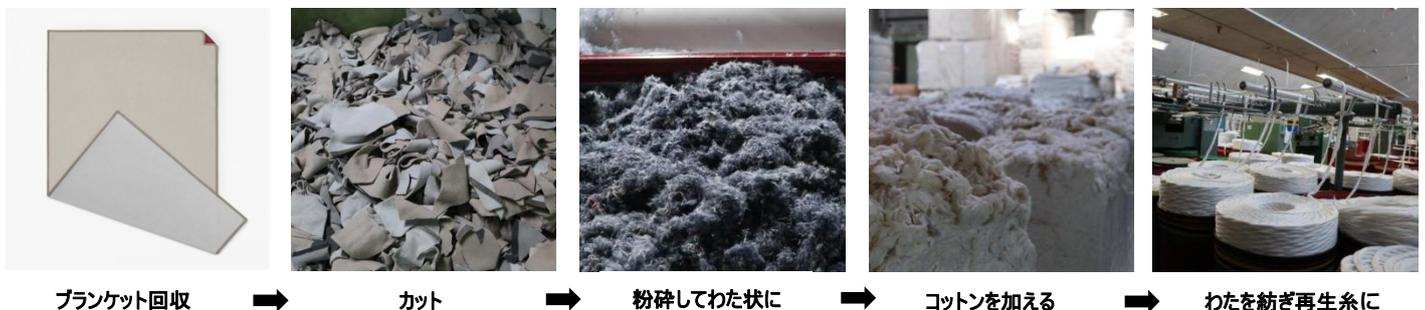
役目を終えた機内ブランケットをクラボウの安城工場にて「カット」「粉碎」したのち、反毛(はんもう)機械<sup>(\*1)</sup>で一度わた状の繊維に戻します。そして、品質を安定させるために新たにコットンを加え、紡いだ再生糸からリサイクル素材の生地が生まれました<sup>(\*2)</sup>。反毛の工程を経てできた再生糸は、新たな衣類や雑貨などに幅広く活用することができます。
